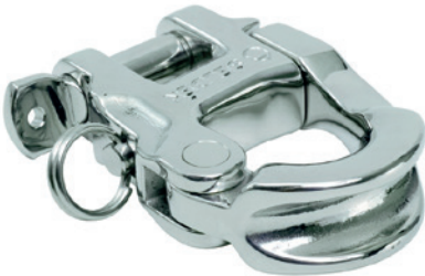
Dieser Schnappschäkel hat einen breiten, gut gerundeten Schnappbügel, durch den Tauwerk mit nur wenig Reibung laufen kann.
