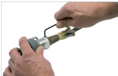
Montage der Verbindung auf das untere Lager bzw. den Fallwirbel.
